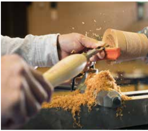
電動ろくろ(木工旋盤)に木地をセットして回転させ、ノミを当てて削っていく。深いものや大きなものは難しく、熟練の技が必要となる
